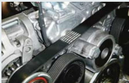
自動車のエアコン、オルタネータ等、多数の軸を1本で回す“自動車用Vリブベルト”
